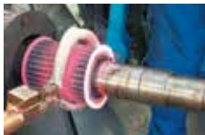
Losmaken van ringen Tandwielen Lusvormige inductor L
