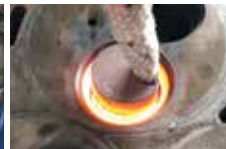
Extractie Ventielzitting Inductor Heat Tube
