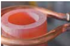
Deblokkeren Moeren / Schroeven / Buizen Lusvormige inductor S/L
